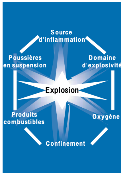
Figure 9 : Mécanisme des explosions de poussières
