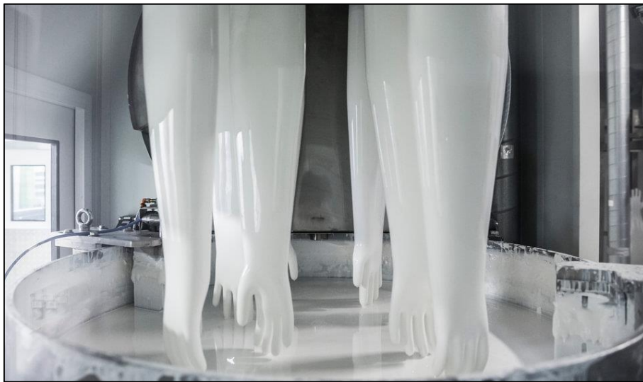
Figure 09 : Fabrication des gants par trempage, PIERCAN.
