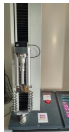
Figure 30 : Dynamomètre permettant les mesures de pression
