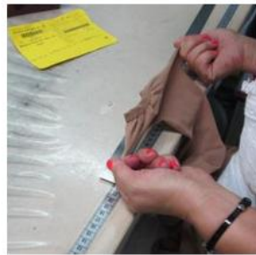
Figure 43 : Employée contrôlant les dimensions d'un article de compression
