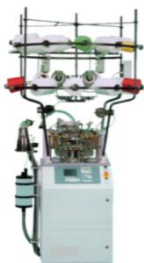
Figure 36 : Photo tricoteuse circulaire
