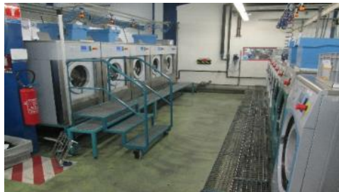
Figure 39 : Machine à laver permettant la teinture de bas de compression médicale
