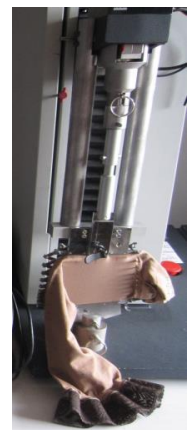
Figure 41 : Contrôle de pression à l'aide d'un dynamomètre
