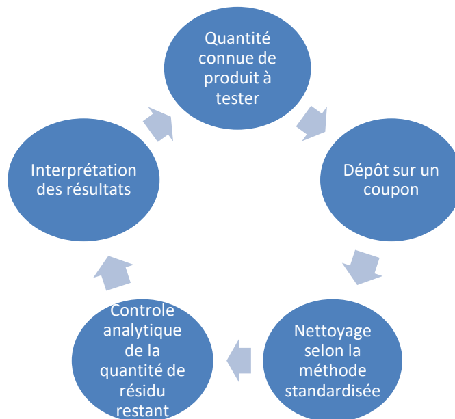
Figure 5 : Schéma illustrant le déroulement des essais en laboratoire pour l'évaluation de la nettoyabilité d'un produit
