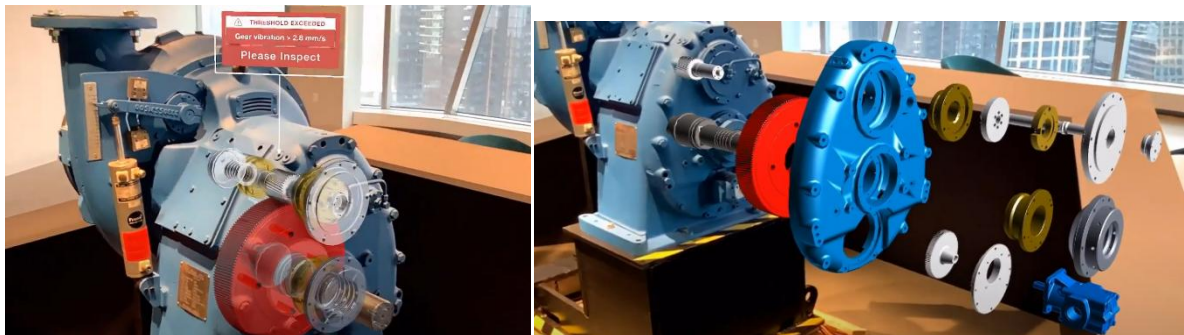
Figure 16 : Utilisation de la réalité augmentée comme guide d'instructions pour maintenance. Par Vulforia Studio.(9)
