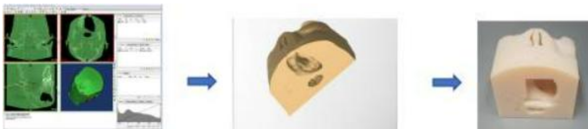
Figure 18 : Processus d'impression 3D de la cavité buccale en vue de faciliter le moulage de prothèses.(11)
