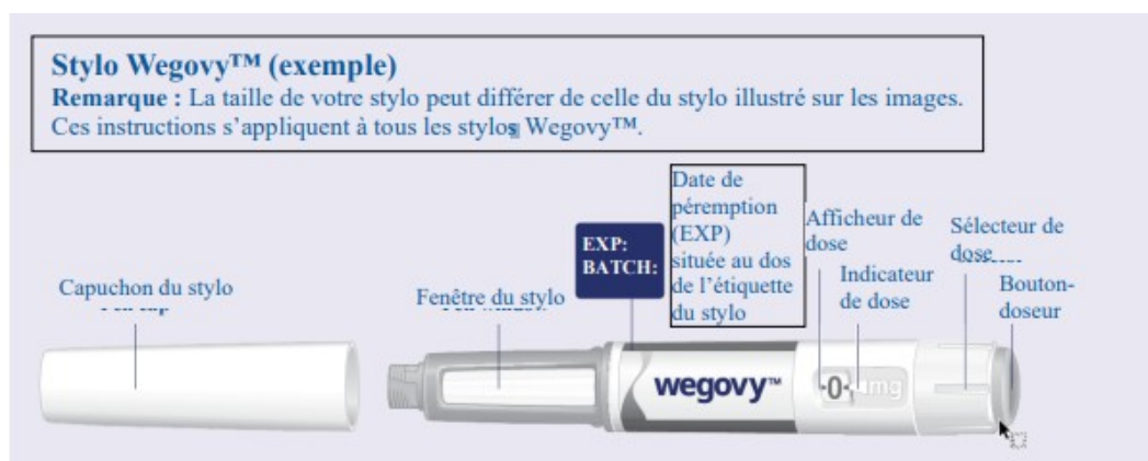
Figure 15 : Schéma présentant les différents composants d'un stylo Wegovy Flextouch Multidoses
