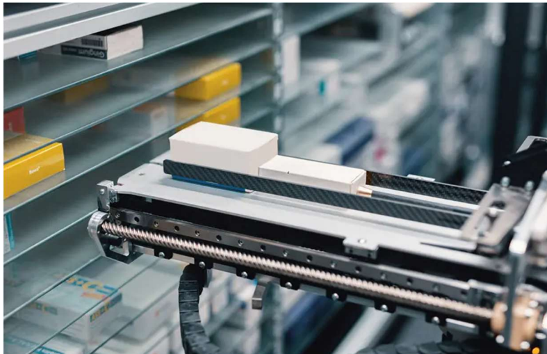
FIGURE 3 : BRAS DE PREHENSION ET ETAGERES (ROBOT VMAX) ISSUE DU SITE ROWA.DE
