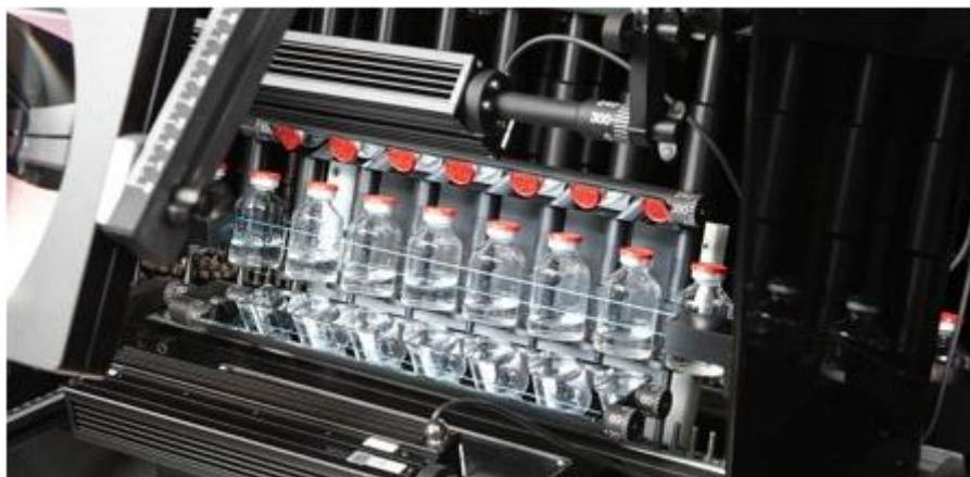
Figure 11 : Image d'une mireuse semi-automatique.
