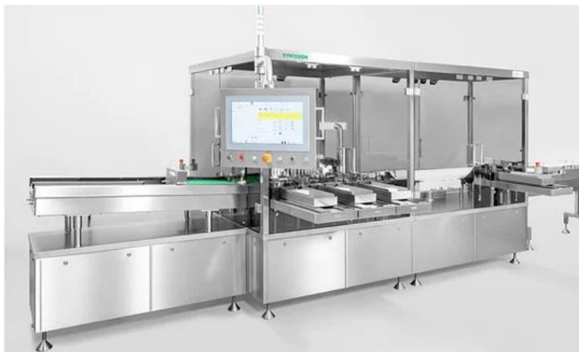
Figure 12 : Image d'une mireuse Automatique.
