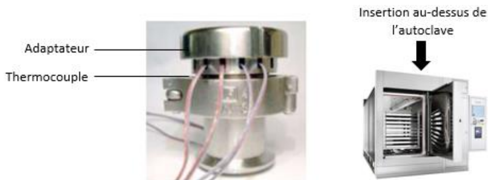
Figure 4. Adaptateur permettant l'entrée de sondes en validation.
