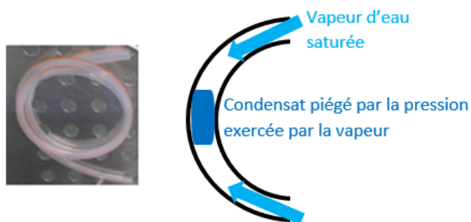
Figure 31. Schéma du design de pièce favorisant la rétention d'air résiduel.
