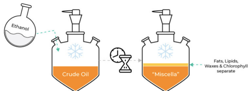
Figure 9 : Schéma du procédé d'hivernage
