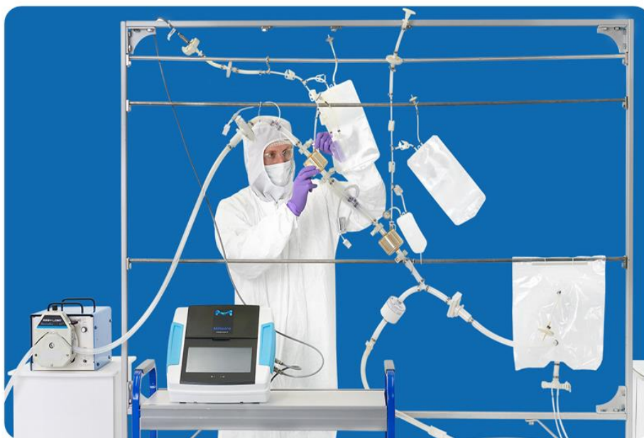
Figure 31: Système de filtration redondant à usage unique - Source Merck Millipore (66)
