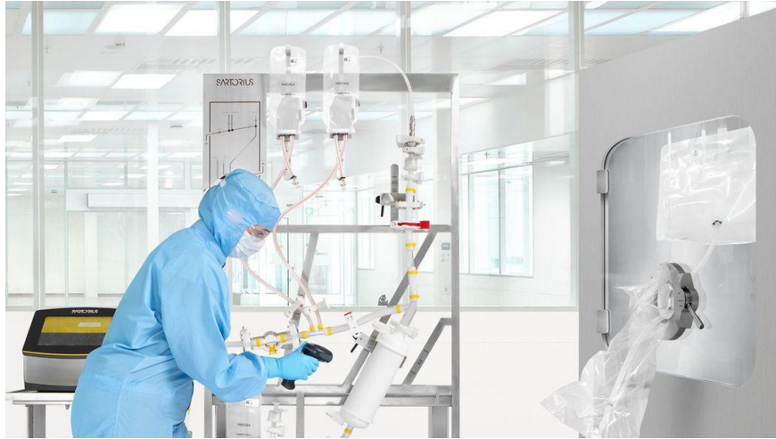
Figure 36: Ligne de transfert à usage unique - Source Sartorius (73)
