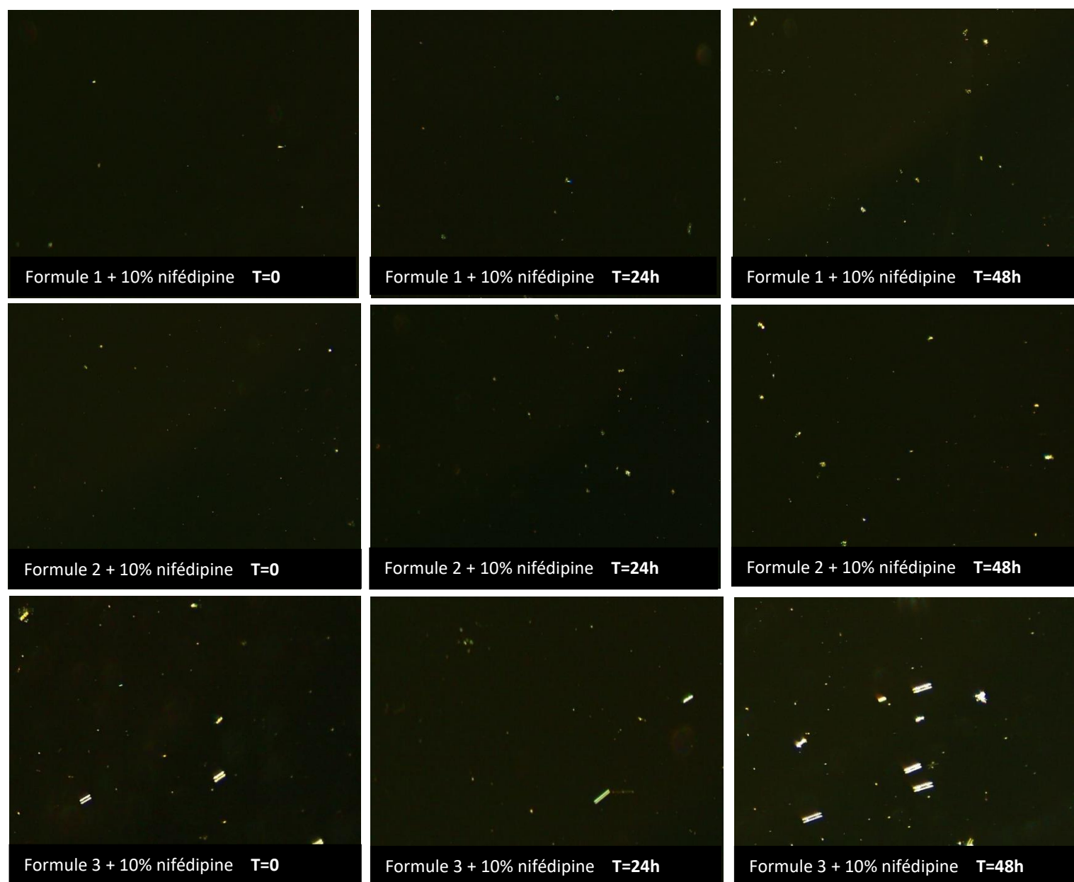
FIGURE 34 : PHOTOGRAPHIES AU COURS DU TEMPS DES DIFFERENTES FORMULES DE SLN CONTENANT DE LA NIFEDIPINE PAR MICROSCOPIE OPTIQUE A LUMIERE POLARISEE
