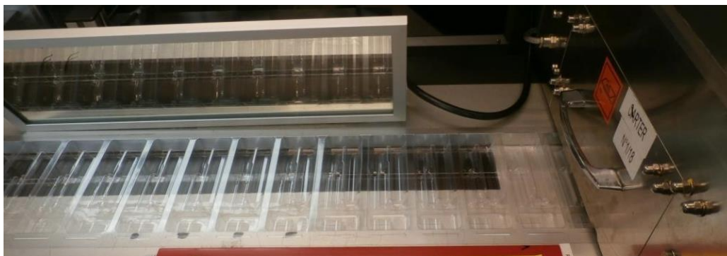
Figure 42: Blisters moulés par la thermoformeuse
