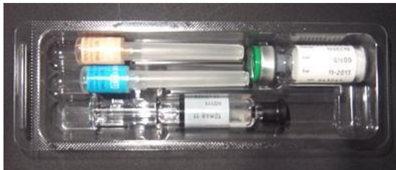
Figure 44: Blister soudé et découpé avec produits – Produit semi-fini
