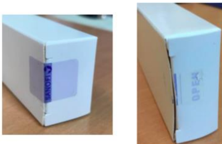
Figure 57: Vignette TESLA laissant un marquage « OPEN » visible sur un étui
