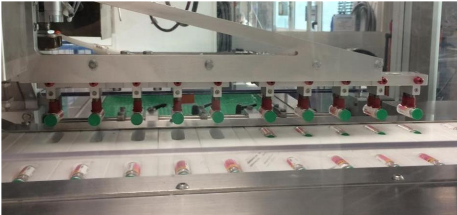
Figure 43: Dépose des flacons par un bras robotisé
