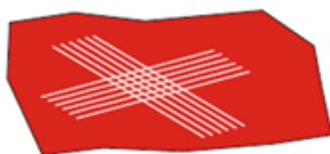
Figure 21 - Griffures en forme de quadrillage réalisées à la surface du film
