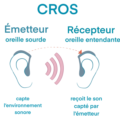
Figure 4: Schéma du système CROS, transfert par voie aérienne (V. Champlong, logiciel Procreate).
