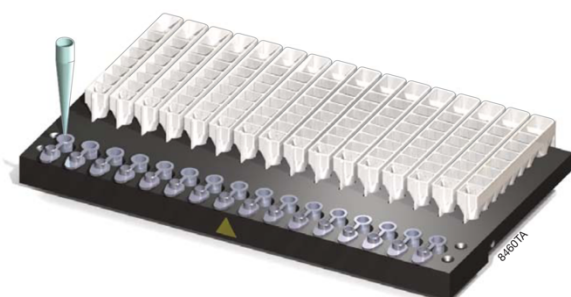
Figure 14. Extraction semi-automatisée des ARN à l'aide de l'appareil Promega Maxwell® et du kit d'extraction Maxwell® 16 LEV RNA FFPE. Les cartouches sont alignés sur la cassette en haut à gauche, les tubes d'élution correspondant à chaque échantillons sont visibles en face (au niveau du cône de pipetage en bas à gauche). La cassette est ensuite placée dans l'appareil (photo de droite).
