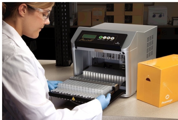
Figure 14. Extraction semi-automatisée des ARN à l'aide de l'appareil Promega Maxwell® et du kit d'extraction Maxwell® 16 LEV RNA FFPE. Les cartouches sont alignés sur la cassette en haut à gauche, les tubes d'élution correspondant à chaque échantillons sont visibles en face (au niveau du cône de pipetage en bas à gauche). La cassette est ensuite placée dans l'appareil (photo de droite).
