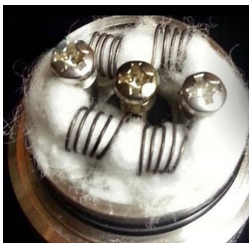
Figure 4 : Exemple de résistance avec sa mèche (image : thevapemall.com)
