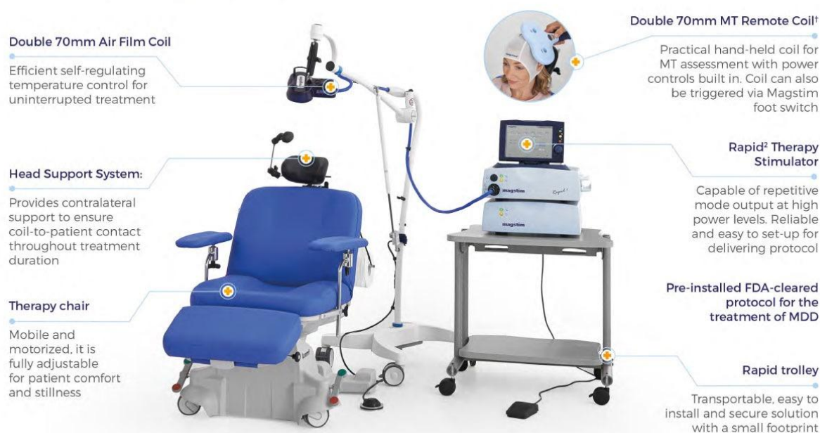
Figure 1 : Dispositif de rTMS
