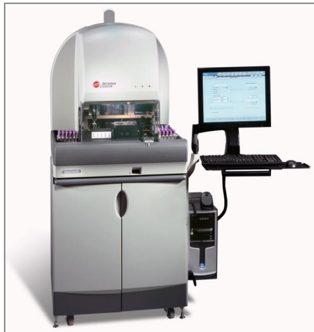
Figure 4 : Beckman Unicel® DxH 800. Il permet la réalisation de 100 analyses de numération formule sanguine par heure.
