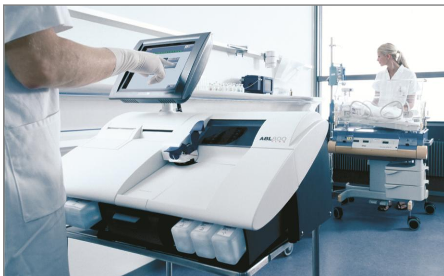
Figure 5 : L'automate Radiometer ABL800 permet les analyses délocalisées de gazométries en réanimation. Il mesure d'autres paramètres, tel que l'hémoglobinémie, la natrémie et la kaliémie. On obtient un résultat d'analyse en moins de 2 min, immédiatement disponible au lit du patient.
