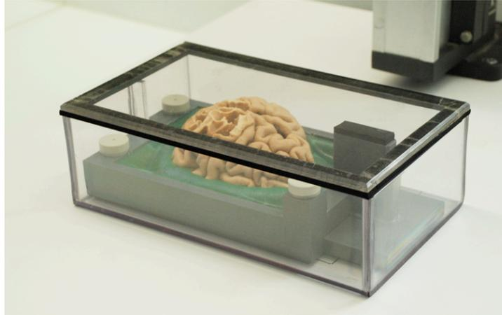
**Figure 6** : hémisphère cérébral fixé sur la platine PVC par une couche de paraffine colorée en vert, installé dans une boîte étanche permettant l'immersion dans de l'eau pour l'acquisition IRM.
