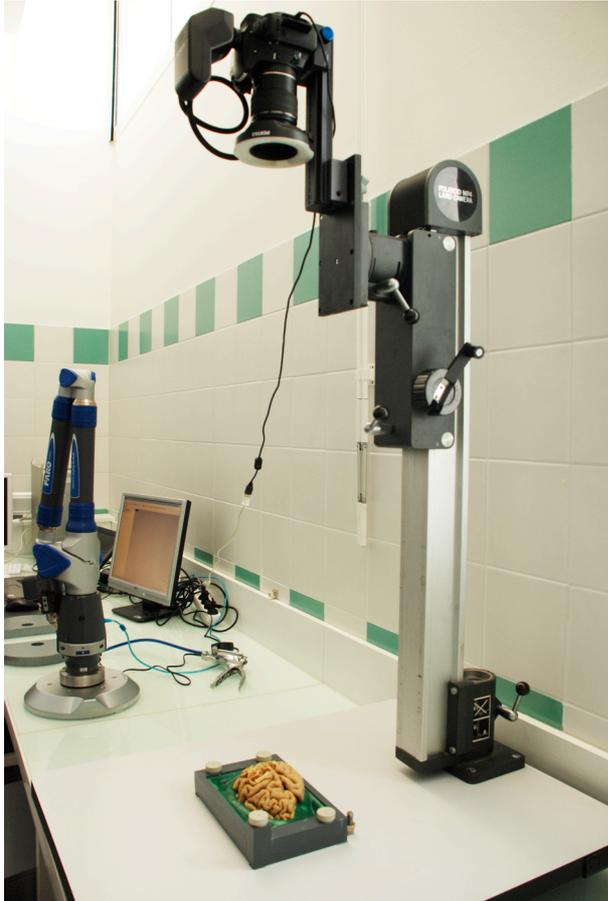
L'appareil photographique Pentax© K-20 est muni d'un objectif D-FA 100mm f/2,8 Macro et d'un flash annulaire Pentax© AF-160 FC, fixé sur une colonne perpendiculairement à la pièce anatomique, et connecté à un ordinateur par un câble USB.
