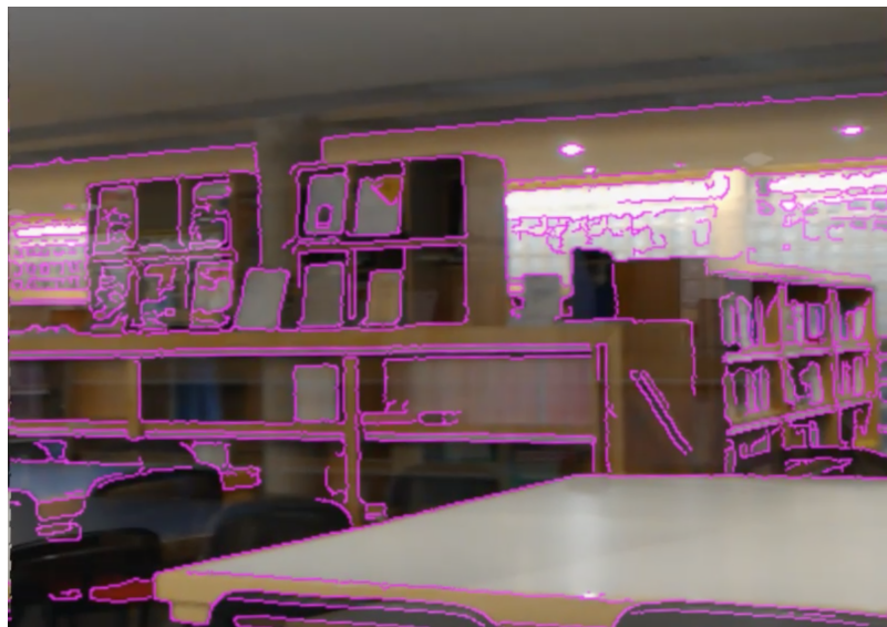
Figure 3 – Exécution de l'algorithme Canny transmis directement sur lunettes
