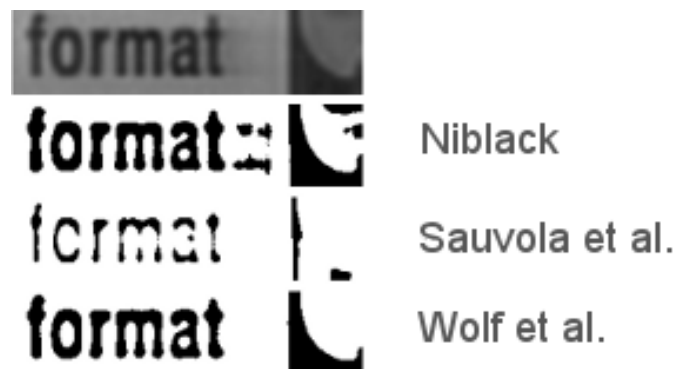
Figure 1 – Résultat de différentes méthodes de binarisation source : [WWW1]
