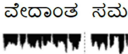
Figure 9 – Exemple de résultat de segmentation de mot avec la méthode de projection de profile
