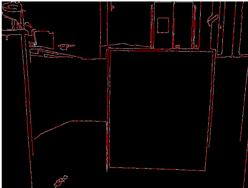
FIGURE 5.19 – Résultat de l'application d'un filtre de Canny puis de la transformée de Hough probabiliste sur une image du labyrinthe capturée par la caméra de Nao. Des bandes blanches ont été appliquées sur les planches du labyrinthe. (3)
