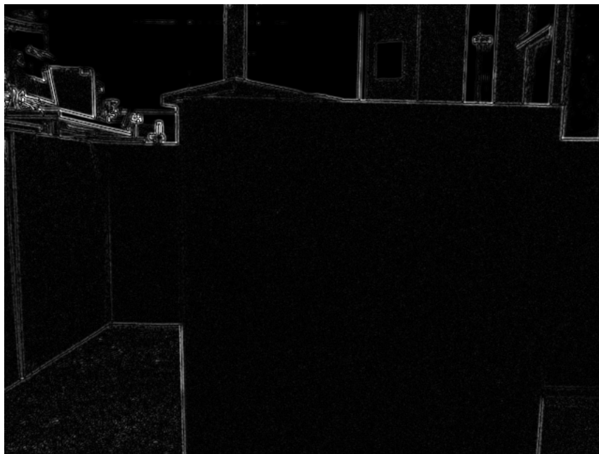
FIGURE 5.3 – Résultat de l'application de l'algorithme de Laplace sur l'image de test
