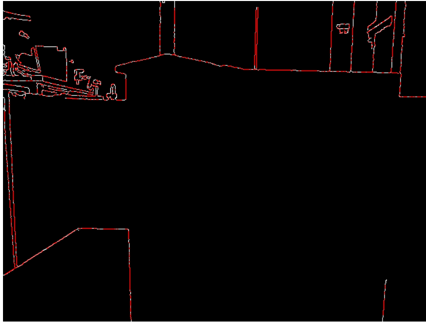
FIGURE 5.5 – Résultat de l'application de la transformée de Hough probabiliste sur l'image de test sur laquelle nous avons préalablement appliqué le filtre de Canny
