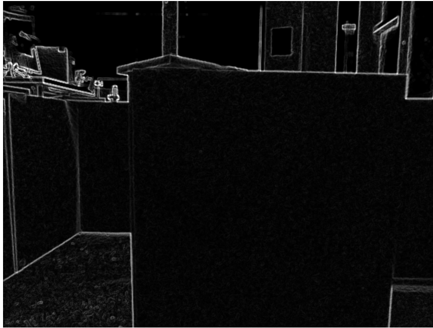
FIGURE 5.2 – Résultat de l'application du filtre de Sobel sur l'image de test
