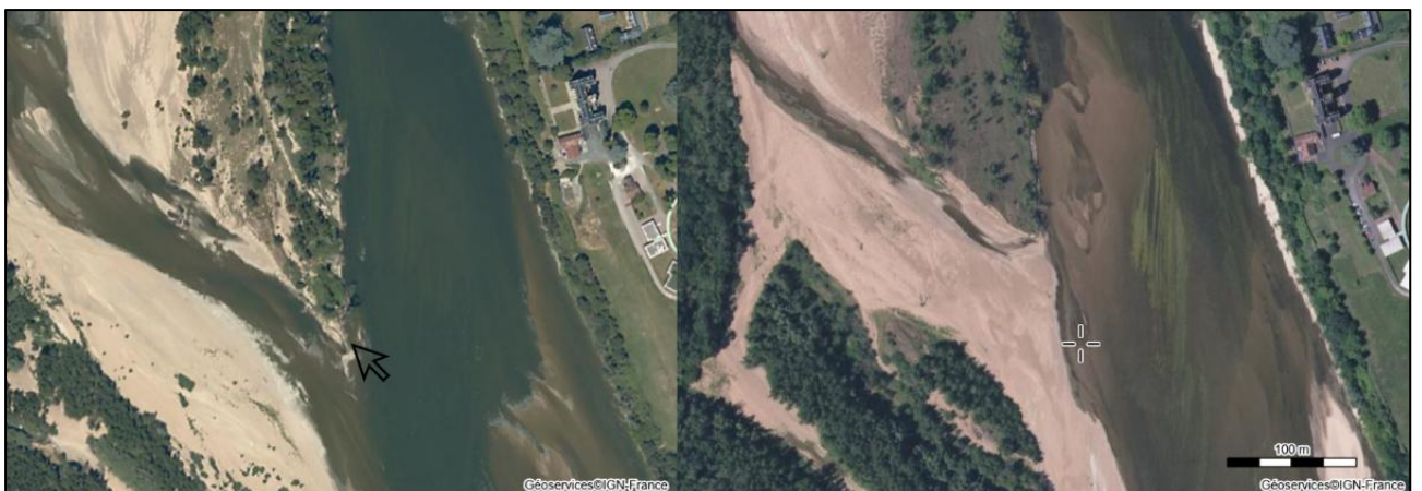
Figure 13. Analyse diachronique des dynamiques sédimentaires de la Loire. Carte IGN (2000-2005) à gauche. Carte IGN (2016-2020) à droite. L'outil « Remonter le temps » de l'IGN permet de visualiser et de comparer des cartes aériennes issues de périodes différentes. A l'aide du mode de comparaison côte à côte verticale qui synchronise les vues et le curseur, on obtient une comparaison spatiale directe d'un même point à des dates différentes.
