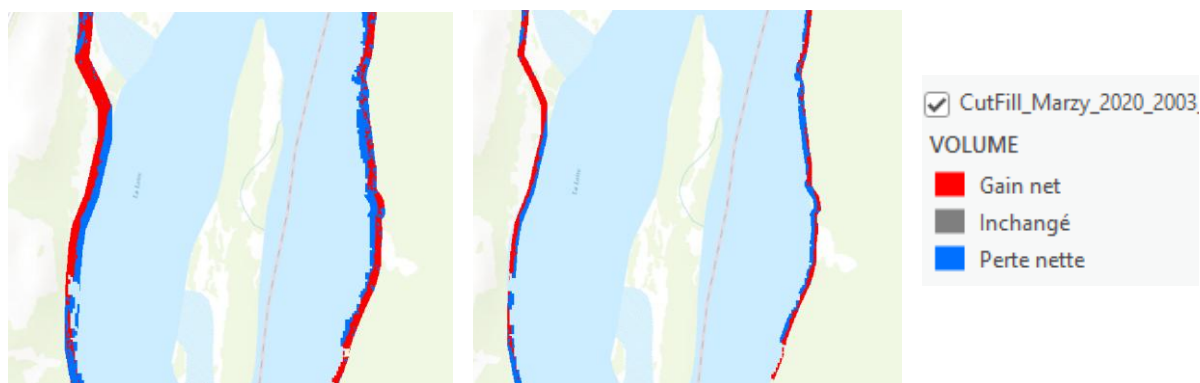
Figure 16 : Exemple de couche de remblais déblais pour Marzy pour la zone de 20 m (à gauche) et de 10 m (à droite)
