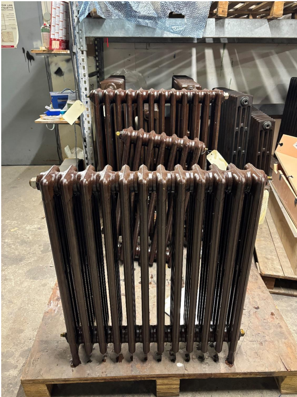
🚦 Radiateur classique « Saint Raphaël » décapé par trempage, désemboué, testé et huilé
