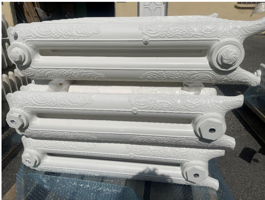
✚ Radiateur type fleuri décapé par trempage, désemboué, testé et thermolaqué
