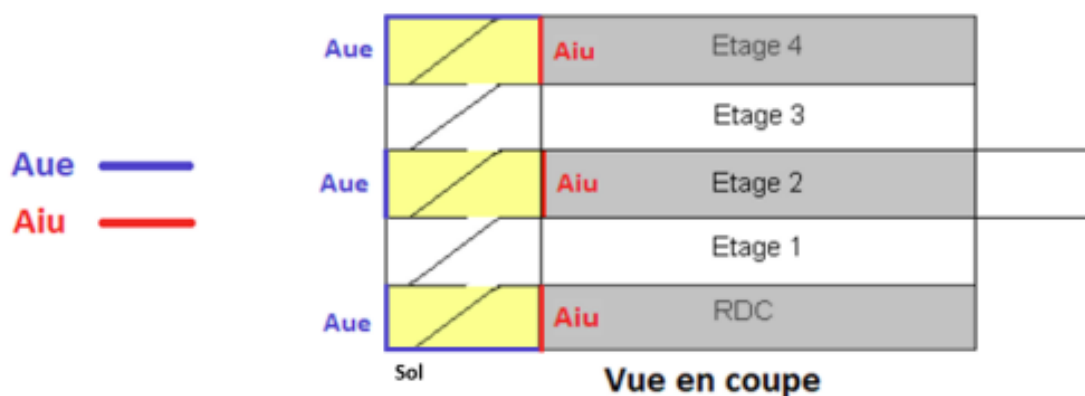
Figure 6 : Méthode de calcul des surfaces Aue et Aiu, Source : Guide du diagnostiqueur DPE
