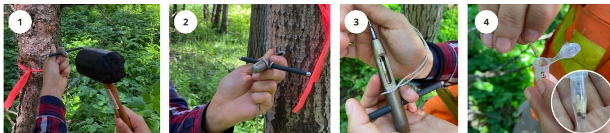
Figure 4 : Étapes de prélèvement des microcarottes de bois, (1) : enfoncer le trephor dans le tronc à l'aide du maillet, (2) : retirer le trephor, (3) : faire coulisser la microcarotte dans la chambre d'extraction à l'aide de l'extracteur, (4) : mettre la microcarotte dans un tube eppendorf
