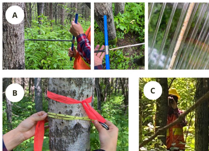
Figure 3 : Utilisation des outils pour la caractérisation des arbres étudiés (a): tarière de Pressler, (b) : Mètre de circonférence, (c) : hypsomètre
