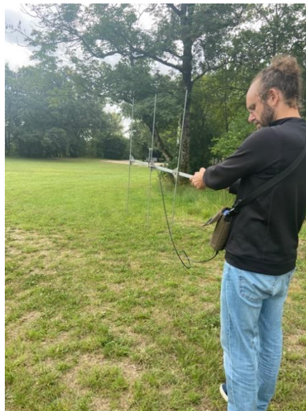
Figure 7.1 : Prise de direction avec l'antenne à la verticale
