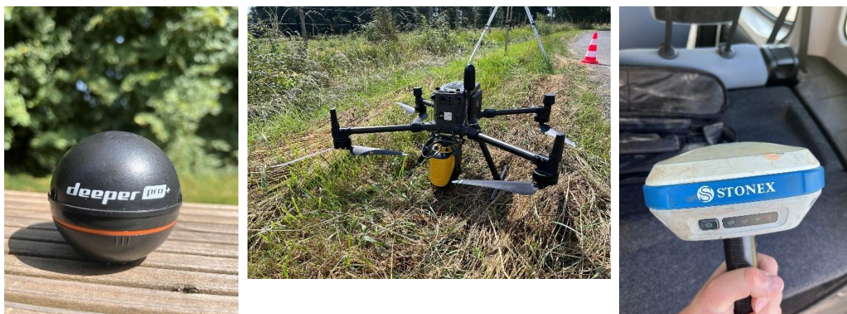
Figure 81: Matériels utilisés pour la réalisation du MNT, de gauche à droite : Deeper Pro+, Drone avec LiDAR Yellowscan Mapper, GPS GNSS Stonex S800 @M. Garnault
