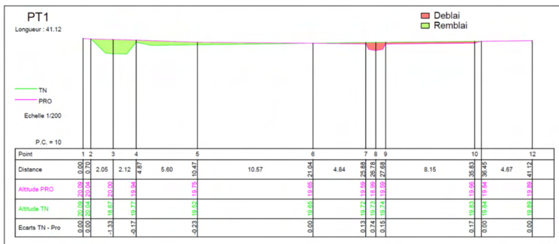
Figure 36 - Profil en travers 1 en amont du projet
