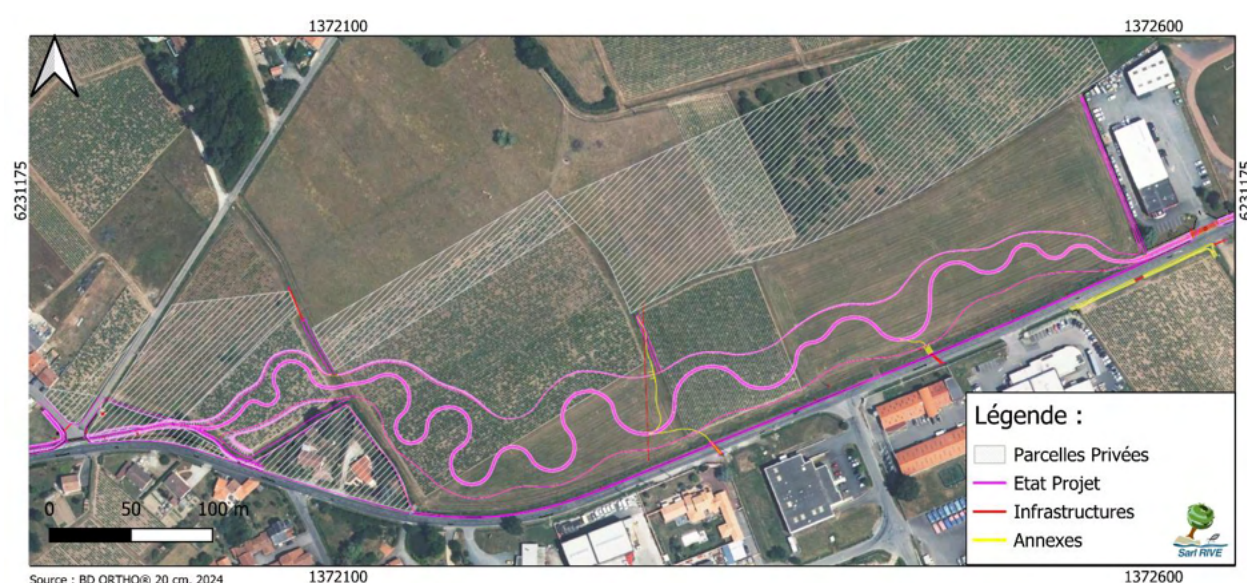
Figure 33 - Prédimensionnement du nouveau tracé du ruisseau de Briacé
