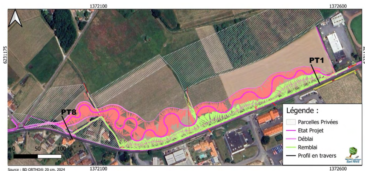
Figure 35 - Localisation des profils en travers
