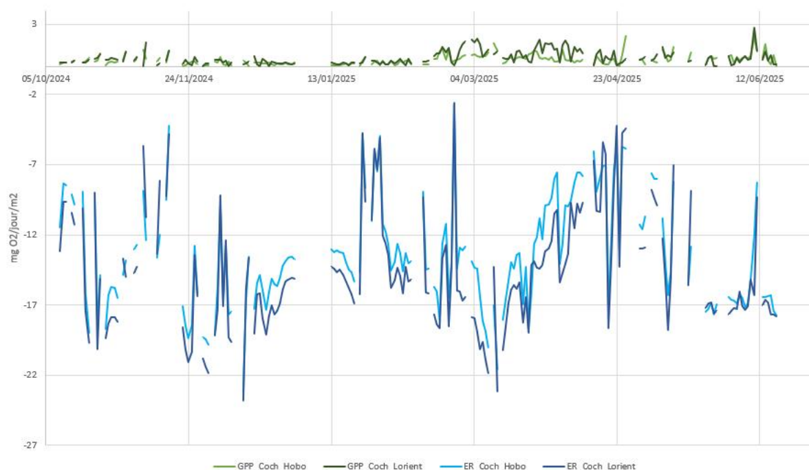
Figure 12: Comparaison des résultats de GPP et ER sur le bassin versant de Cochelin en fonction des données de lumières provenant de la station météo de Lorient ou du dispositif HOBO situé à l'exutoire de Cochelin
