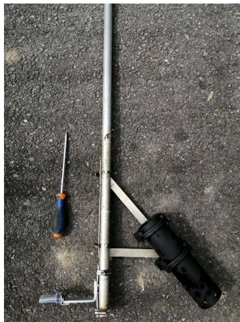
Figure 4: Photographie d'une sonde MiniDot sur son support fabriqué par l'UMR SAS
