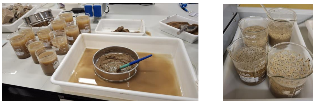
Figure 12 : Filtration des sédiments inférieurs à 2mm et élimination de la matière organique
