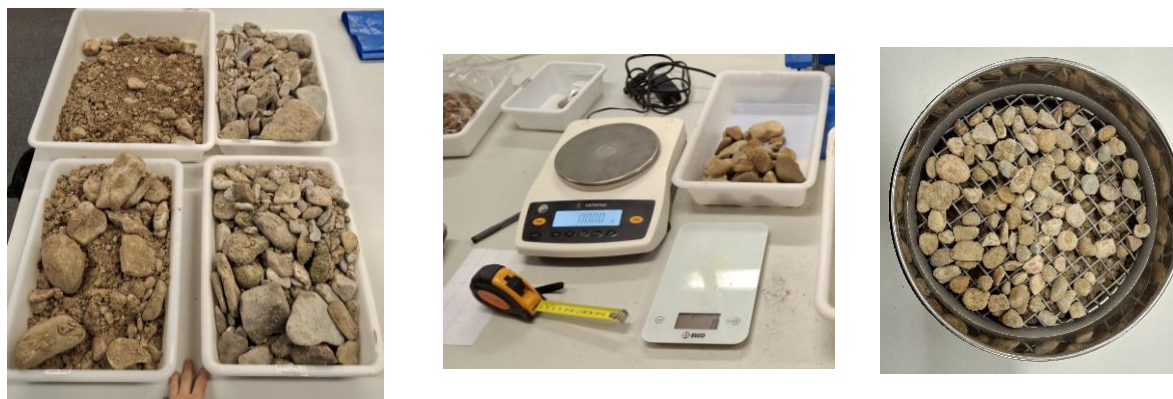
Figure 11 : Mesure et tamisage des particules de plus de 2 cm de barres sédimentaires
