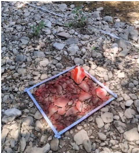
Figure 10 : Echantillonnage par quadrat avec les sédiments de surface (à gauche) et les sédiments de subsurface (à droite)
