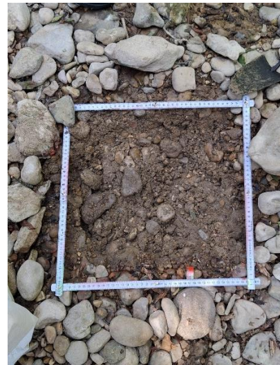
Figure 10 : Echantillonnage par quadrat avec les sédiments de surface (à gauche) et les sédiments de subsurface (à droite)
