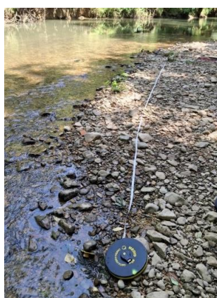
Figure 8 : Réalisation du protocole de Wolman sur la barre sédimentaire
