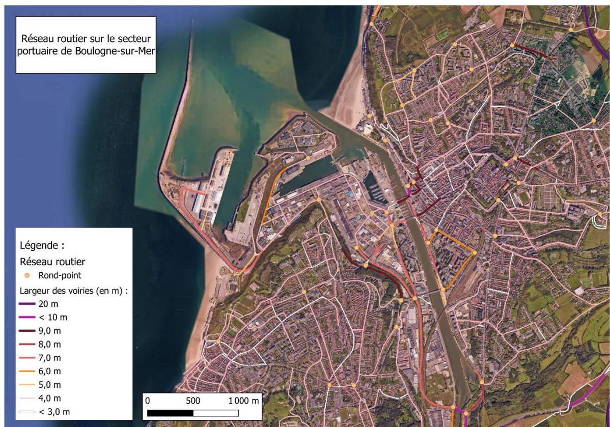
Figure 10 : Exemple de carte faite sur QGIS illustrant les enjeux d'accessibilité PL par le réseau routier à Boulogne-sur-Mer en fonction de la largeur des voiries
