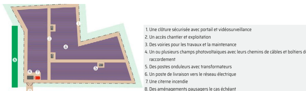
Figure 4 : Composition d'une centrale photovoltaïque dites « au sol »
