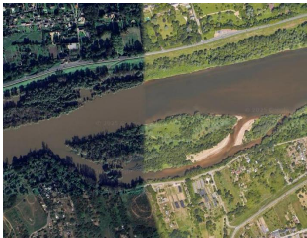
Figure 6 : Bifurcation alluviale stable avec une configuration asymétrique à la Riche
