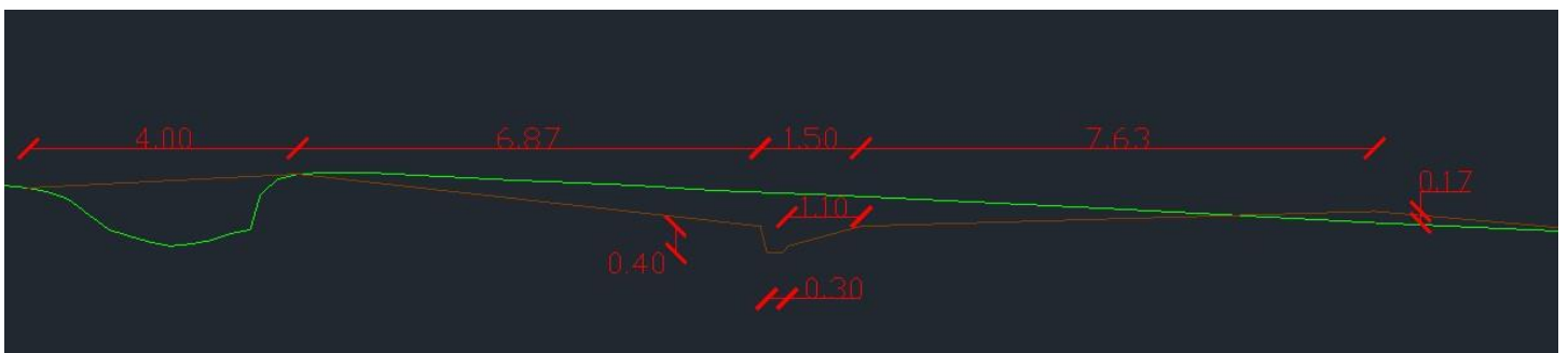
Figure 14 : Exemple de dimension d'une fosse sur un transect
