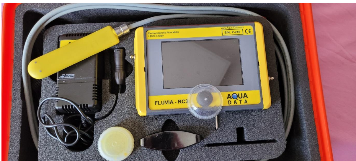
Figure 9 : Photo de la sonde et du boîtier utilisé pour les mesures de débit
