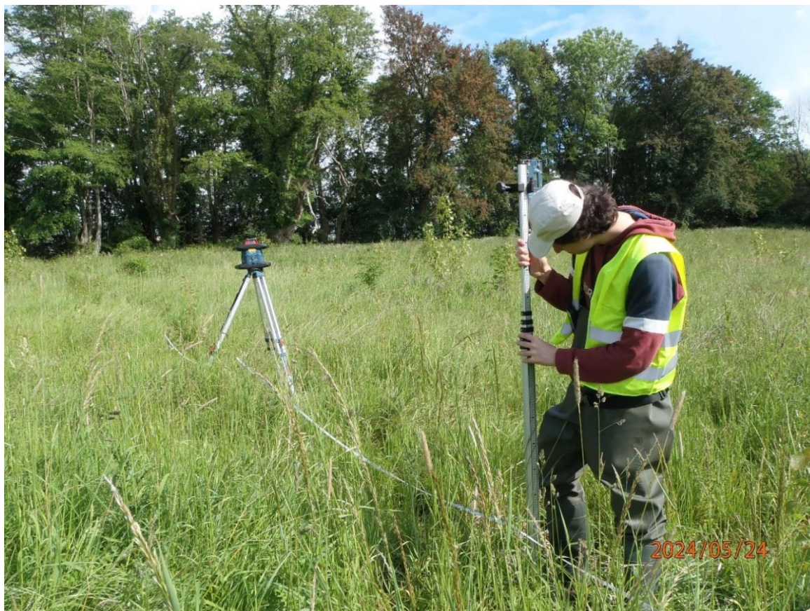
Figure 7 : Photo du laser et de la mire avec cellule de détection durant un relevé topographique
