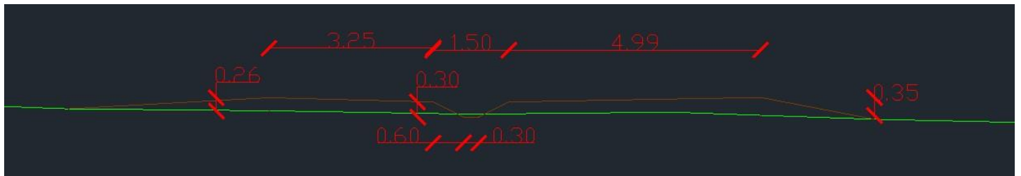
Figure 13 : Exemple de dimension d'un radier/plat courant sur un transect
