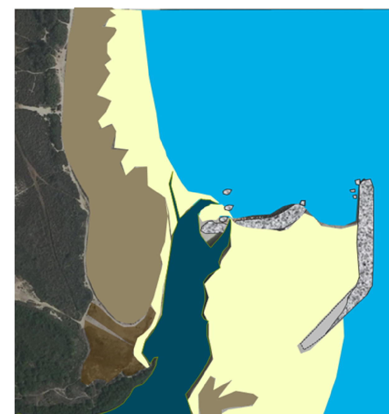
Encoche d'érosion et contournement du débouché à l'enracinement de l'épi
