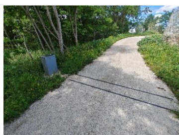
Figure 13 : Compteur à bandes piézoélectriques découvert sur site sur la commune de Perpignan. Travail personnel
