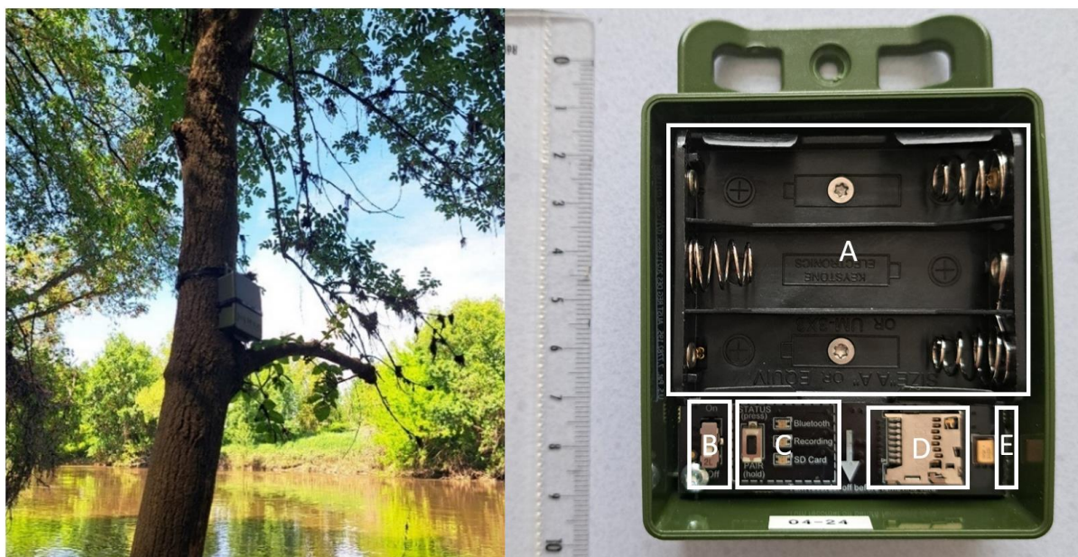
Figure 6 : Enregistreur Song Meter Micro sur le site de Lilette, sur la Creuse : (A : Compartiment à piles, B : Switch ON/OFF, C : Statut, D : Emplacement de la carte SD, E : microphone).
