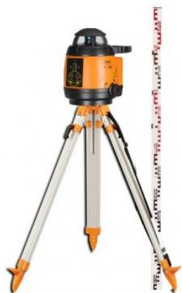
Figure 5 : Mire et laser rotatif utilisés pour les relevés topographiques (Source : www.mesure-laser.com )
