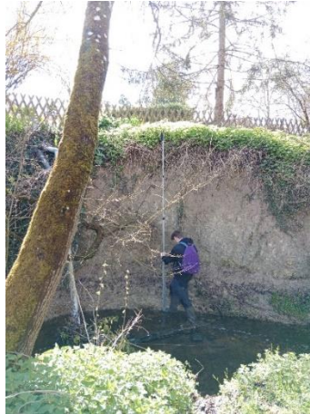
Figure 14 : Exemple de mesure prise lors de la visite terrain : hauteur de la berge la plus abrupte de la zone d'étude
