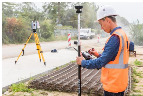
Figure 27 : Instruments manipulés lors de ces sorties de terrain, station totale Focus 50 motorisée et prisme. (Source : Spectra geospatial, 2024)
