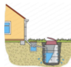
Figure 11 : puit d'infiltration – © Constructeur Travaux
