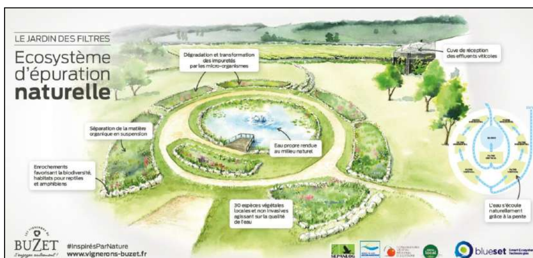
Figure 4. Plan détaillé du Jardin des Filtres. Source : Les Vignerons de Buzet révolutionnent la station d'épuration viticole en un écosystème intégré
