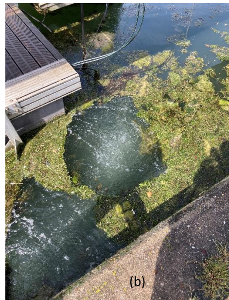
Figure 10 : (a) schéma du fonctionnement du déflecteur à bulles (TEO, 2024), (b) deuxième prototype du déflecteur à bulles en fonctionnement à la darse du vieux port ( bassin des Yachts) de La Rochelle (N. Durand).
