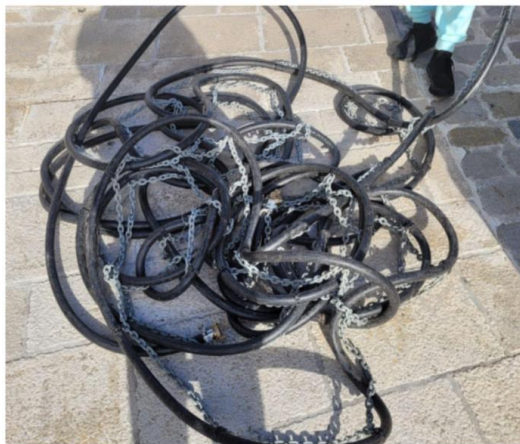
Figure 20 : photo du premier prototype de déflecteur à bulle réalisé par les étudiants ingénieur d'EIGSI (TEO,2023).
