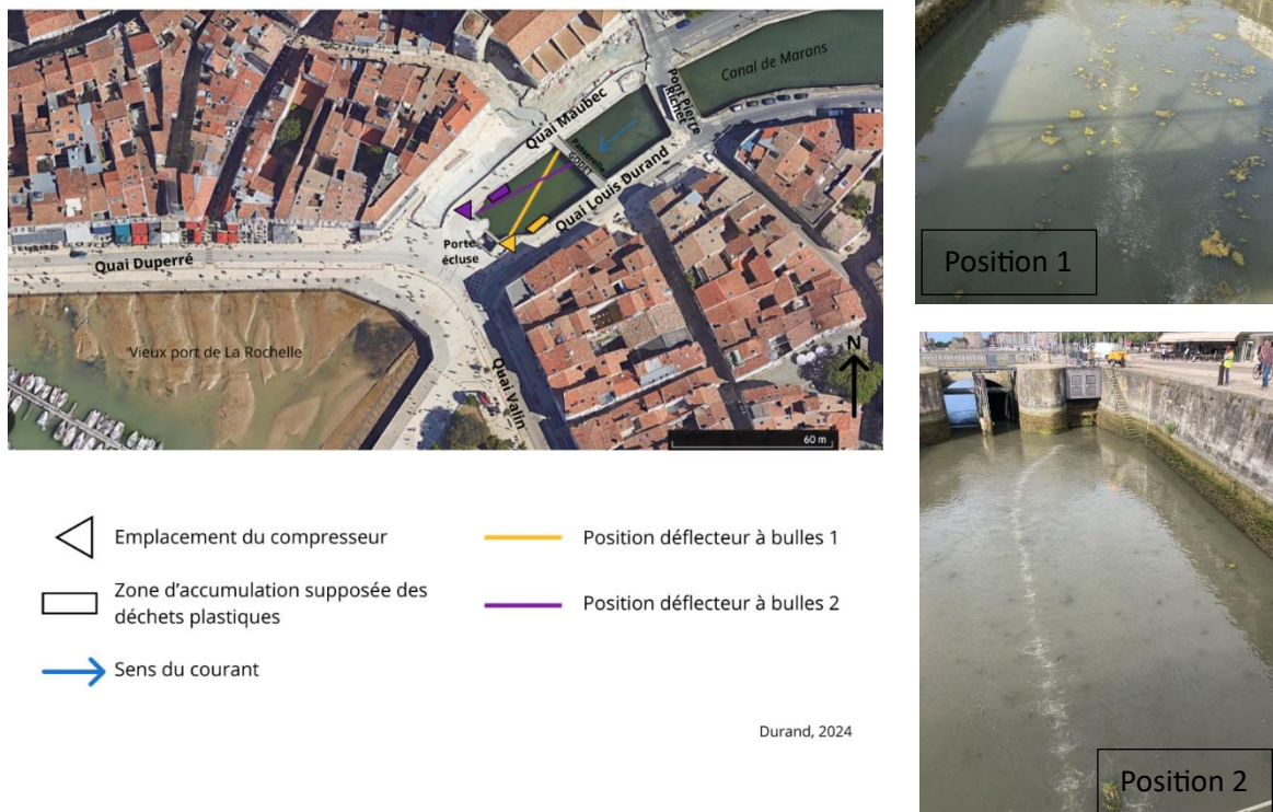
Figure 21 : Localisation de la mise en place du déflecteur à bulles lors de la journée test du 5/07/2024 et prise de vue lors des tests (Google earth, Durand, 2024).
