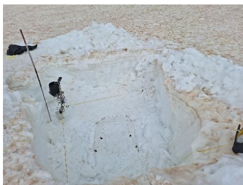
FIGURE 6 : PLEXIGLASS UTILISE POUR RECHAUFFER LA ZONE CONCERNEE (26 JUIN 2024)
