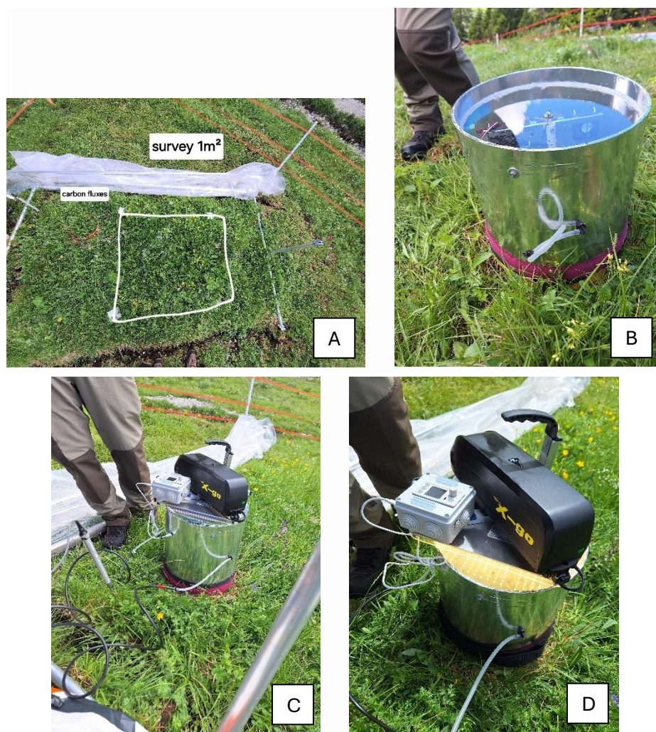
FIGURE 3 : SURFACE ETUDIEE ET APPAREIL DE MESURE DES FLUX DE CARBONE POUR L'EXPERIMENTATION WARMING AND DROUGHT (4 JUILLET 2024)
