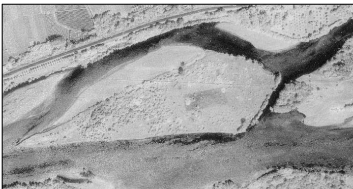
Figure 21 : Obstruction des écoulements vers le chenal nord par le déplacement de l'île située en amont (@Remonterletemps.ign.fr, 1972)
