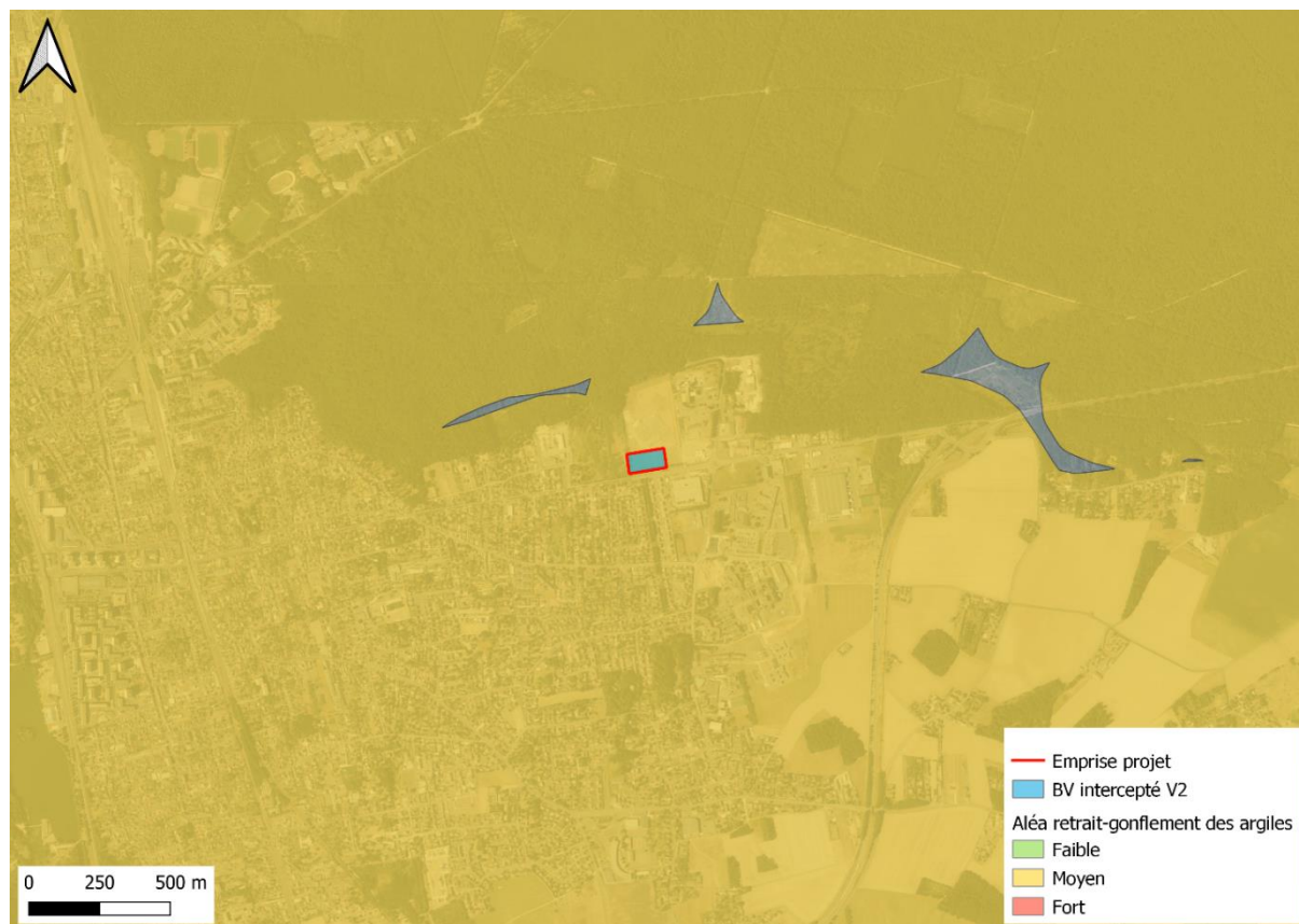
Figure 9 : Exposition vis-à-vis de l'aléa retrait-gonflement des argiles (Maxence Paris, source Géorisques)
