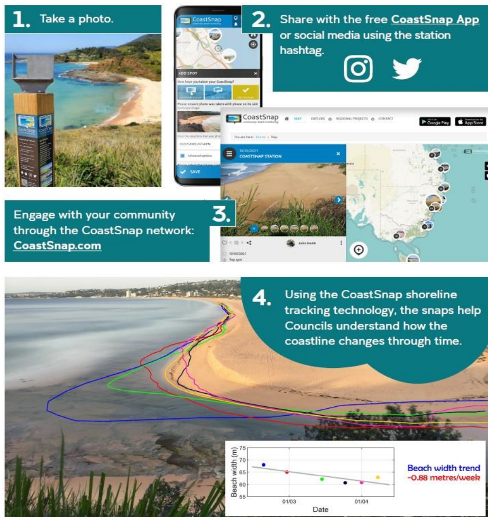
Figure 10 : Explication du fonctionnement du dispositif CoastSnap
